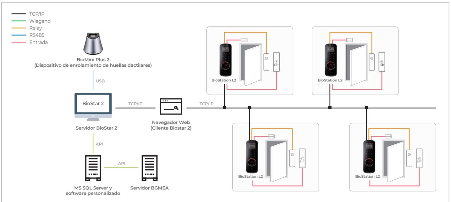
Plataforma de seguridad integrada abierta basada en web BioStar 2
