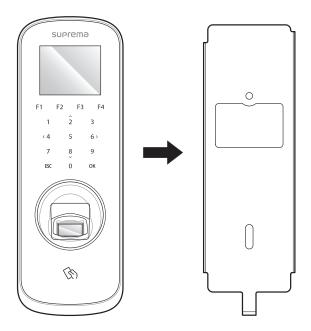
**3** BioStation L2의 제품 고정용 나사를 돌려 BioStation L2와 브래킷을 조립하십시오.
